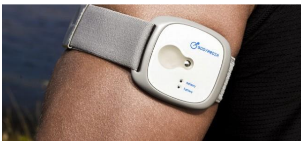
Armbåndet skal sidde, så måleapparatet vender således.
