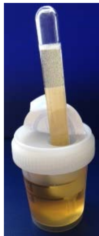
Pres prøverøret (9 mL) ned over studsens og røret fyldes automatisk
