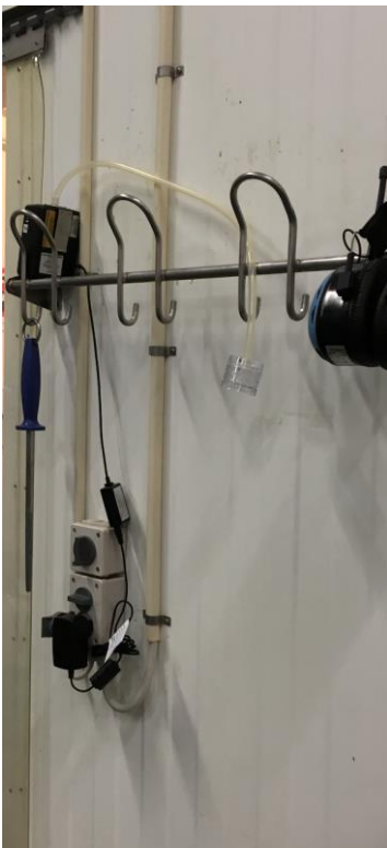
Foto 1. Stationær partikelopsamling med filter i filterkasette tilsluttet pumpe.
